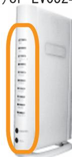
※正常動作時は、電源、インターネット回線、電話の各ランプが緑色に点灯します。
